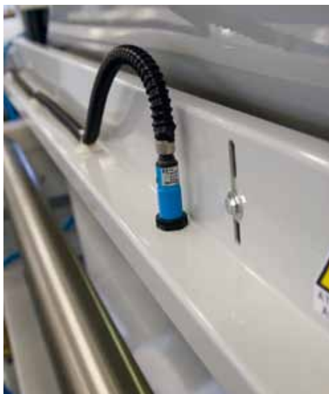
Fotocellula di comando per impianto di tubi soffiatori superiori/inferiori Control photocell for upper/lower blowing pipes plant Photocellule de commande pour l'installation tubes souffleurs supérieure/inférieure Photozelle zur Steuerung von oberer/unterer Gebläseanlage Fotocélula de mando para instalación de tubos sopladores superior/inferior
